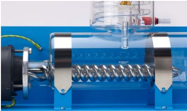
Heizelement und Boiler
