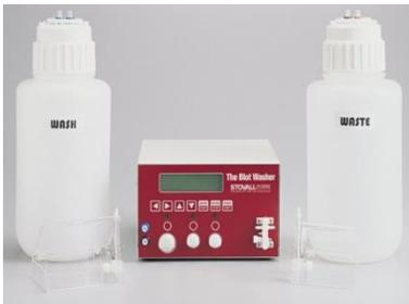
Der programmierbare Blot Washer wurde zur Automatisierung von Blotting-Prozessen entwickelt und ermöglicht die Blot-Entwicklung mit denselben Parametern, wodurch Abweichungen deutlich reduziert werden. Er automatisiert die Waschschrte, Inkubation und das Dispensieren von Reagenzien, einschließlich des Sekundärantikörpers.
