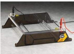
Das JSB-96 System eignet sich zur schnellen Auftrennung von Proben mit geringen Agarosemengen (100 ml). Es ist ideal für PCR-, RFLP und Plasmidanalyse. Das JSB-96 Mikrottestplatten-Format ermöglicht die Analyse von Proben sowie Markern und Negativkontrollen in weniger als 90 Minuten. Die Kämme des Mikrottestplatten-Formats wurden für eine schnelle Beladung des Gels mit einer Multikanal-Pipette entwickelt, lassen aber auch Platz für Molekulargewichts-Marker.
