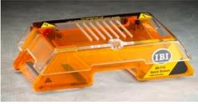
Das QS-710 System wurde für die schnelle lineare Auftrennung von Nukleinsäuren entwickelt. Es benötigt nur einen minimalen Aufbauaufwand und ermöglicht eine hervorragende Auflösung der Banden und einheitliche Bandenbewegung für genaue Ergebnisse. Das QS-710 eignet sich für eine Vielzahl von Anwendungen, die eine schnelle Auftrennung (30 Minuten oder weniger) erfordern, wie z.B. Fragment- und Rekombinationsanalyse.
