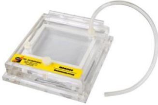
Der Immunoblotter bietet eine einfache und ökonomische Möglichkeit, Primär- und Sekundärantikörper auf Membranen aufzutragen. Er reduziert die Menge an benötigten Antikörper-Lösungen sowie Puffern und braucht für seine Funktion keinen Laborschüttler.
